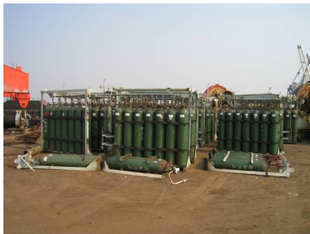
图 4.56 处理船上压力容器瓶
