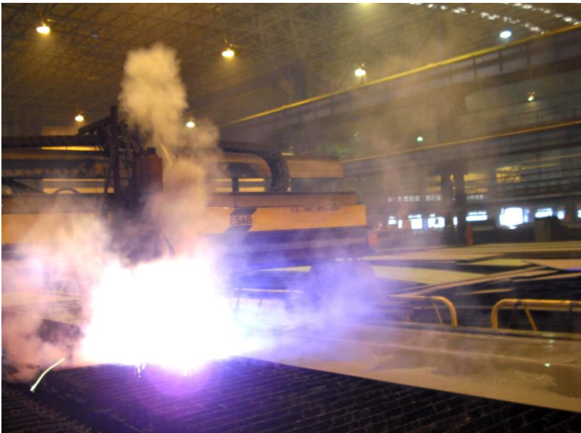
图 4.31 未开启吹风助力装置焊接现场
