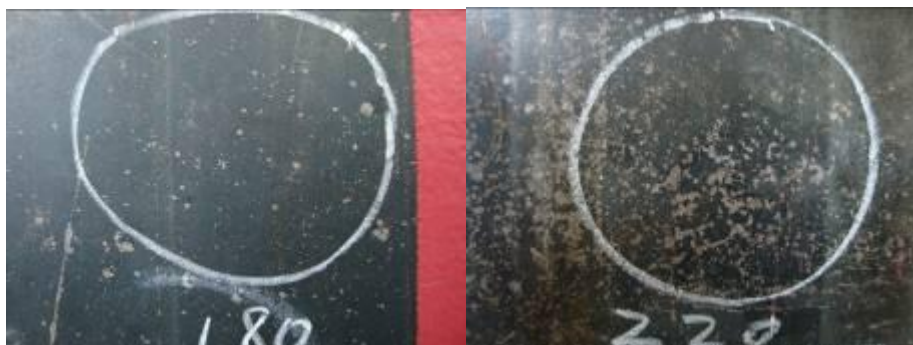
图 6.4 除锈除漆表面（180MPa、220MPa）
