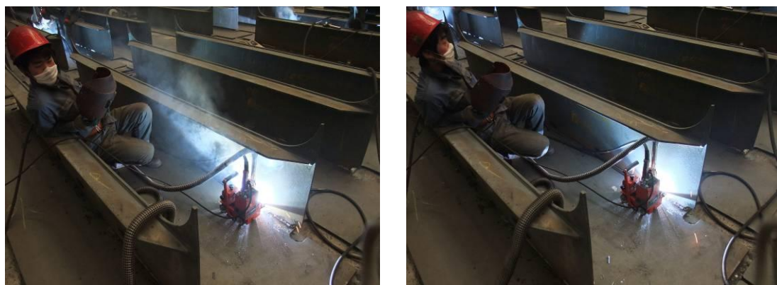
图 4.35 高真空焊烟净化系统运行效果对比（小车焊）
