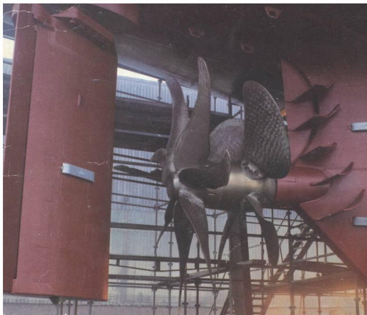
图 5.2 导轮+桨前整流鳍技术方案
