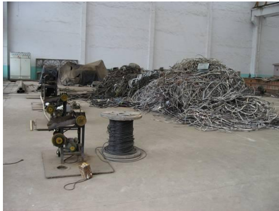
图 4.49 剥线机剥离电缆金属
