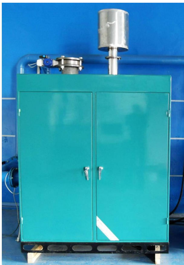
图 4.33 高真空焊烟净化系统
